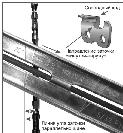
Рис. 26 Определение угла заточки
